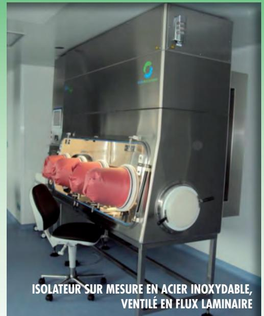
ISOLATEUR SUR MESURE EN ACIER INOXYDABLE,
